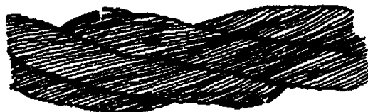
Рисунок 1. Обрывы и смещения проволок каната крестовой свивки
