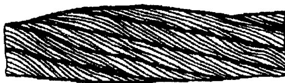
Рисунок 13. Местное увеличение диаметра каната
