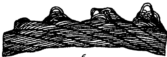
Рисунок 12. Выдавливание проволок прядей: а - в одной пряди; б - в нескольких прядях
